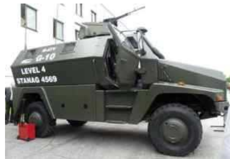
На выставке в Кельце польская компания Dom Samochodowy GERMAZ SP. Z O.O. представила машину, аналог американской M-ATV — машину высокой проходимости с противоминной защитой.
