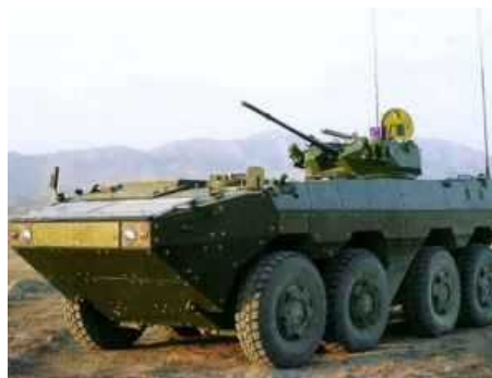
Китайская государственная корпорация NORINCO предложила рынку свою новую разработку — VN1, колесный бронетранспортер с колесной формулой 8x8.
