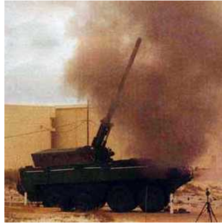
Разрабатывается ряд новых модификаций для боевых систем будущего (FCS) армии США, в частности, артиллерийской системы NLOS-C (обозначение XM 1203) для ведения огня с закрытой позиции.
