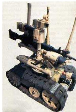
SWORDS - версия наземного робота фирмы Foster Miller, снабженная телепередающей быстроснаводящейся платформой, дистанционно управляемая, изготавливается фирмой Precision Remotes.
