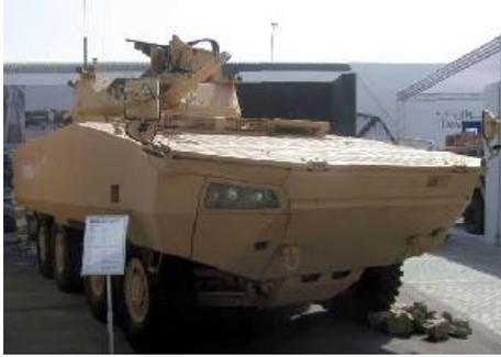
Он подтвердил, что эти машины имели расширенный корпус таким образом, чтобы на них могла быть установлена башней от российской БМП-3, которую ОАЭ хочет сохранить у себя на вооружении. Новая машина 28А также имеет расширенный корпус, но более старые машины, проданные в 2006 году не были такими тяжелыми, как представленная на IDEX 2017 машина, которая весит 28 тонн.
